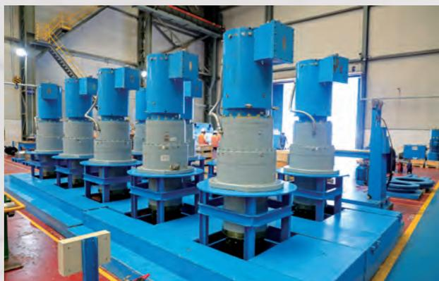
公司城建盾构核心配套件主驱动减速机打破国外垄断
