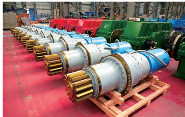
系列化盾构主驱动减速箱正在进行包装、等待发运
