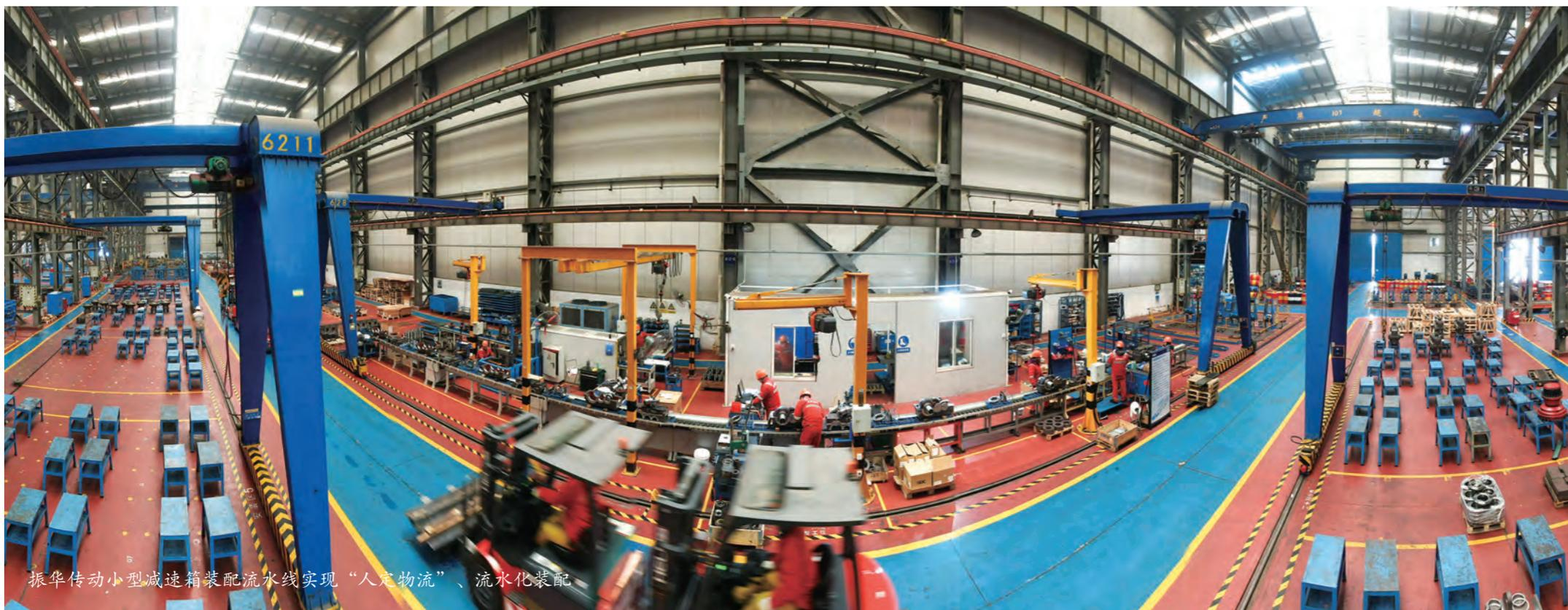
振华传动小型减速箱装配流水线实现“人定物流”、流水化装配
