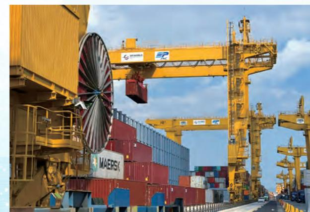
自动化超高空箱轨道吊正在抓放集装箱
