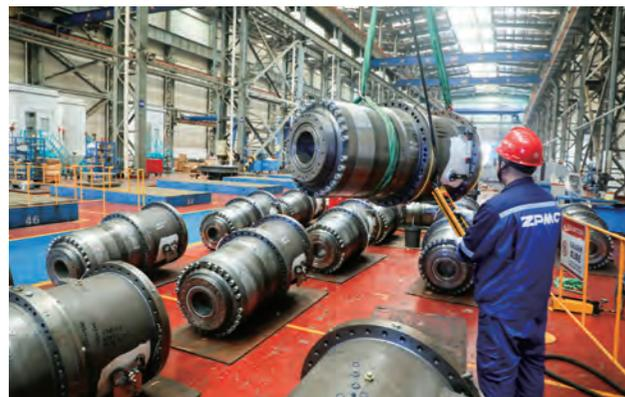
2025年3月，18台液压自动换挡双速比盾构主驱动减速箱成功下线
