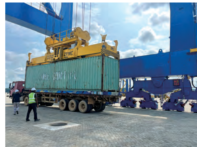
项目人员正在进行岸桥集卡定位系统调试
