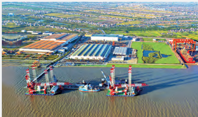
“海峰 1001”及“海峰 1002”自航自升式风电安装平台
