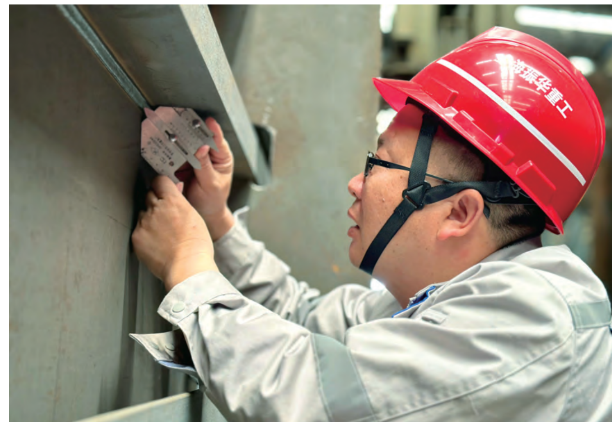
包孔正在进行焊缝外观检测
