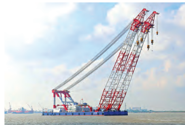
中国同类起重能力最大双臂架变幅式起重船“二航卓越”
