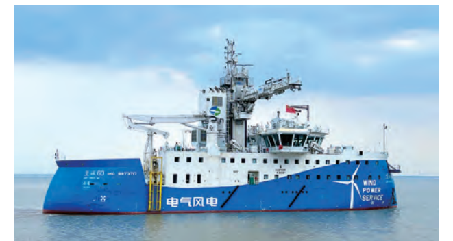
“至诚 60”搭载 ZPMC 自主研发的中国首套风电运维母船波浪补偿栈桥
