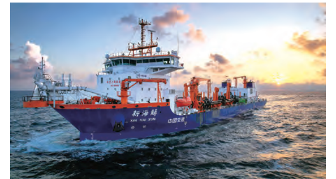
中国首艘 LNG 双燃料动力耙吸式挖泥船“新海鲟”轮
