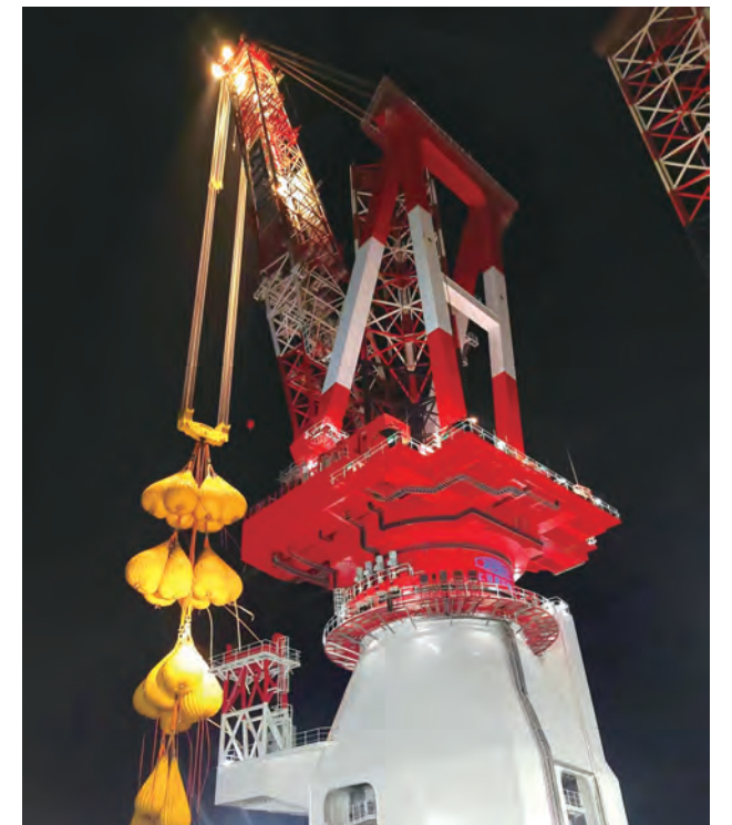
“中天 31”风电安装平台搭载 1600 吨起重机
