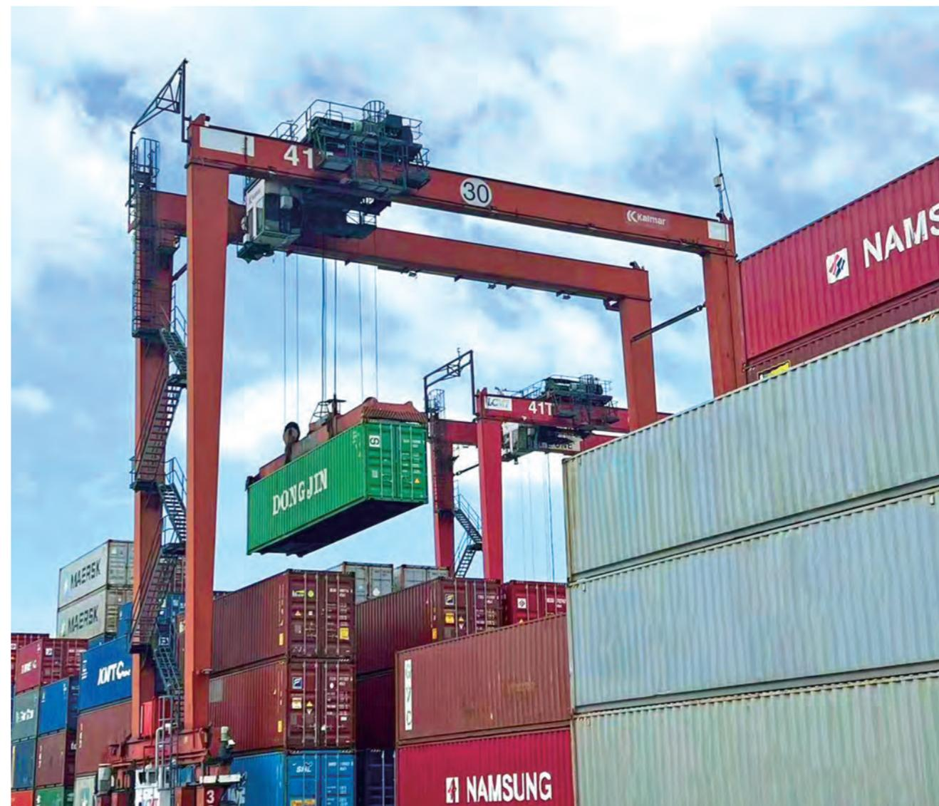
完成“油改电”的轮胎吊正在装卸货物
