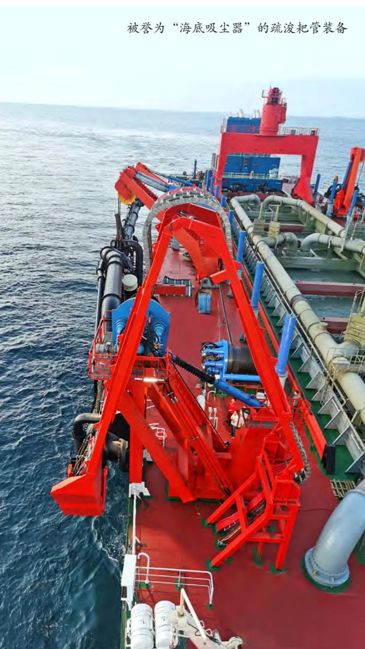
2024年6月下旬,一艘26800方的大型耙吸挖泥船在长江出海口迎来首次挖泥试验。只见驾驶室内工作人员按下按钮,船体两侧各配备的一套巨型耙管在耙管绞车的牵引下,犹如两条巨大的触手没入波涛之中且以稳定的姿态缓缓下沉至海底。随着船体稳健地航行,海底泥沙在强大的吸力作用下通过耙管系统被不断吸入船体泥舱内,整个过程流畅高效。
