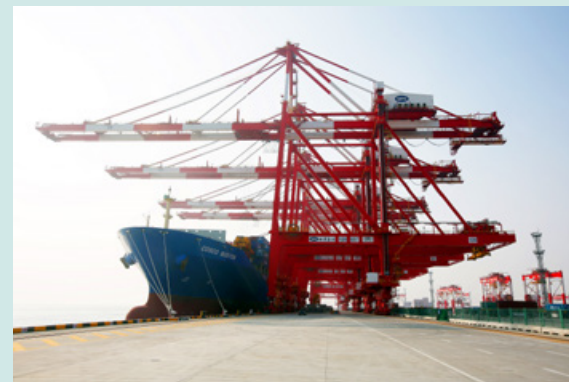
振华重工研制的双 40 英尺箱双小车岸桥。
