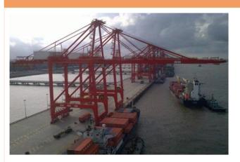
节能型岸桥:通过上海市节能中心检测,顺利实现了节能10%的设计指标,岸桥起升、小车行走、下降在规定动作内节电率为12.5%,大梁俯仰节电率为10%,大车行走节电率达18%。以每年300工作日计算,五台岸桥每年可节电574145度,折合232吨标准煤,二氧化碳减少排放572吨。
