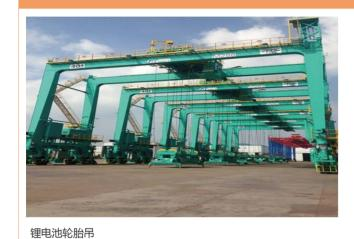
锂电池轮胎吊:通过降低功率配备和吸收再生能量达到平均油耗 0.374L/TEU,节油率达 60%以上,峰值噪音降低约 15dB。
