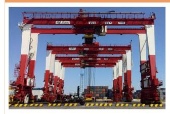
LNG 与锂电池混合动力场桥: LNG 与锂电池混合动力,有大容量锂电池组动力 +50Kw 小燃气机组充电的强混合形式,燃料成本节约 50.6%,排放降低二氧化碳 43.6%;大燃气机组动力(约280Kw)+小电池(或电容)能量回收利用(约50Kw)的弱混合形式,燃料成本节约 21.5%,排放降低二氧化碳 12.8%。
